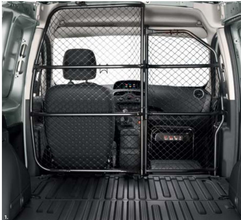
**1. Antepara em rede basculante.** Em função das necessidades, permite carregar objetos longos, com total segurança para o condutor. Tapete de revestimento do compartimento de carga em borracha.
