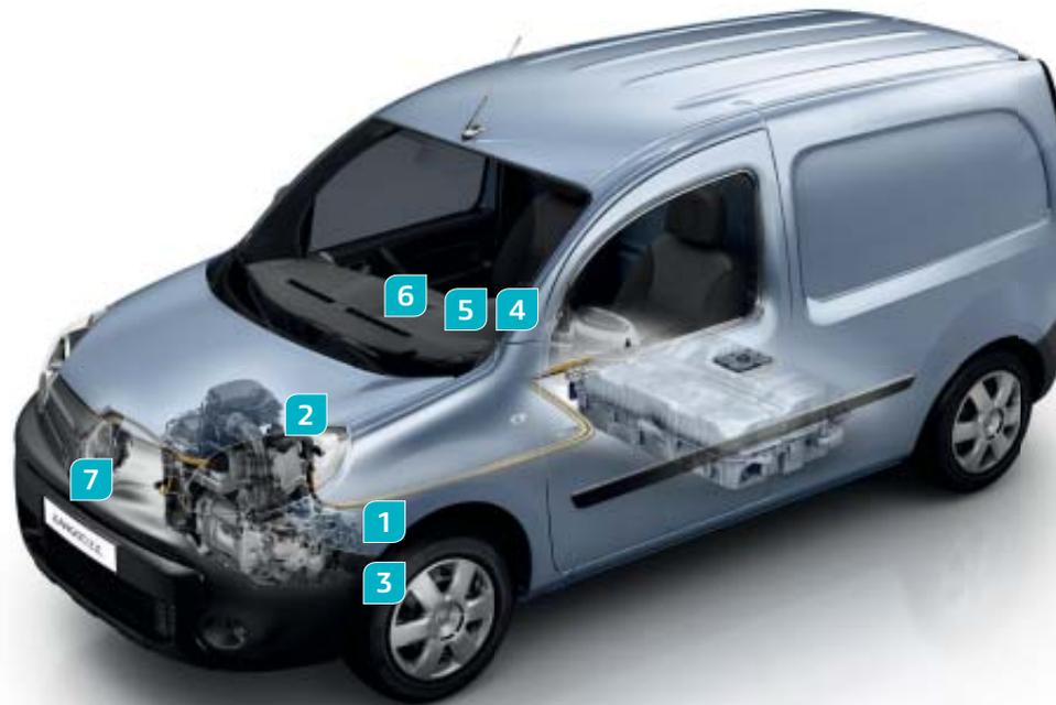
**1) Travagem regenerativa:** A bateria é recarregada quando levanta o pé do acelerador ou quando pressiona o pedal do travão.
