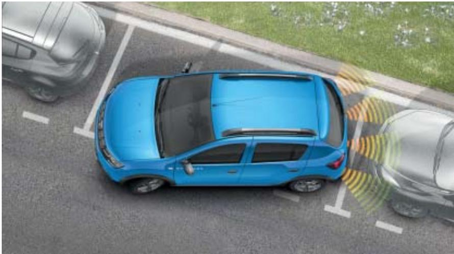
**O sistema de ajuda ao estacionamento traseiro\***: este dispositivo alerta o condutor para a presença de obstáculos situados atrás do automóvel, através de uma sequência de «bips». Para aumentar o seu conforto e a sua segurança, pode ainda adicionar uma câmara de marcha-atrás a este equipamento, consoante a versão.
