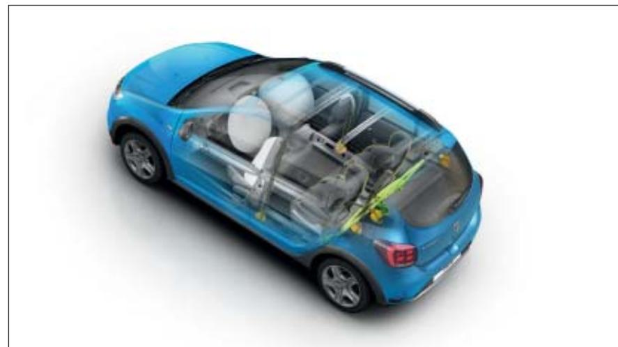
**Proteção:** Estrutura reforçada, airbags frontais e laterais dianteiros, sistema de fixação ISOFIX nos lugares laterais traseiros.
